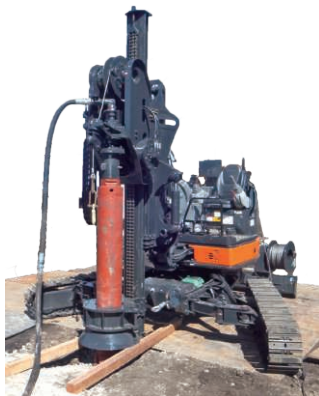
クローラ開脚状況 (SC-TEPドリル2号機)
