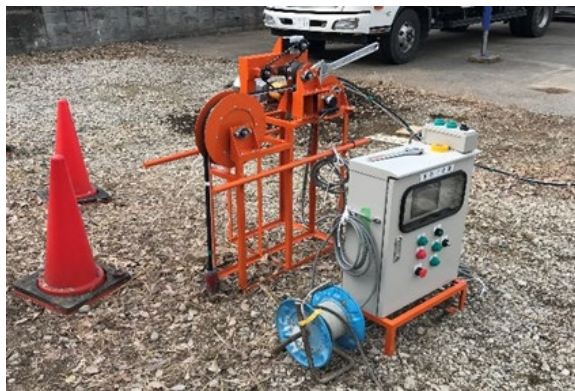
注入ホース巻き上げ装置の計測試験状況とモニター画面
