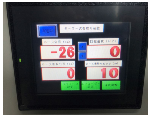
注入ホース巻き上げ装置の計測試験状況とモニター画面
