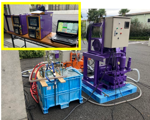
Grout Conductor の動作確認試験の実施状況と確認結果
