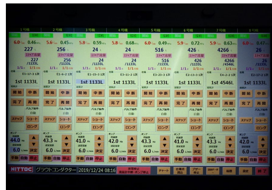
Grout Conductor による注入管理状況
