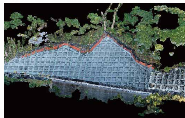
点群作成ソフトによる3次元モデル (点群データ) の作成
