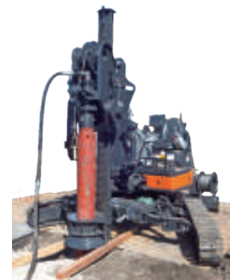
クローラ開脚状況 (SC-TEPドリル2号機)
