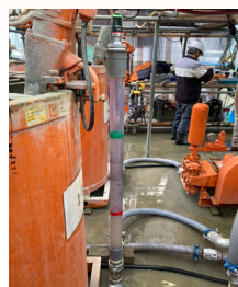
▶レーダー式ミキサー残量計◀ レーダー式の液面反射によってミキサー内部の溶液の残量を表示する。
