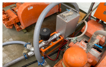
▶レーダー式ミキサー残量計◀ レーダー式の液面反射によってミキサー内部の溶液の残量を表示する。
