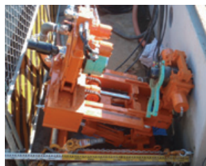
1.5mの幅があれば施工可能
