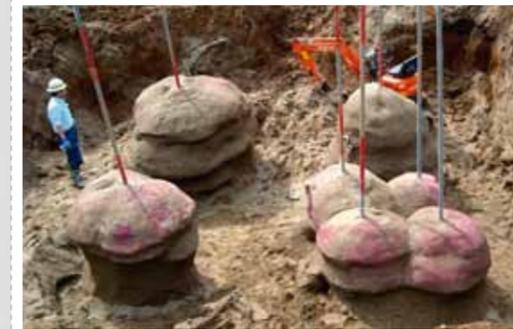
砂質地盤を対象として、MXグラウト長結型による実物大規模の浸透注入・改良体造成実験を行いました(スリーブ注入工法で試験)。その結果、全ての注入孔で、理想的な浸透注入による計画径以上の改良体が確認され、優れた浸透性能が実証されました。
