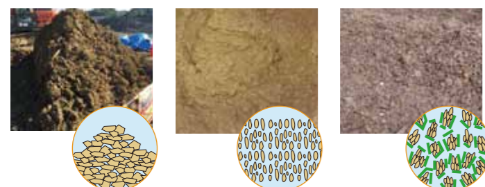
特別な保管方法を必要とせず、即時に使用可能 液状限界をやや超える程度に加水攪拌し、流動化 即時に再泥化しない粒状に改良
