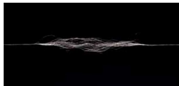
連続繊維補強土に使用する繊維は、ポリエステルフィラメント(連続繊維)を使用しています。
