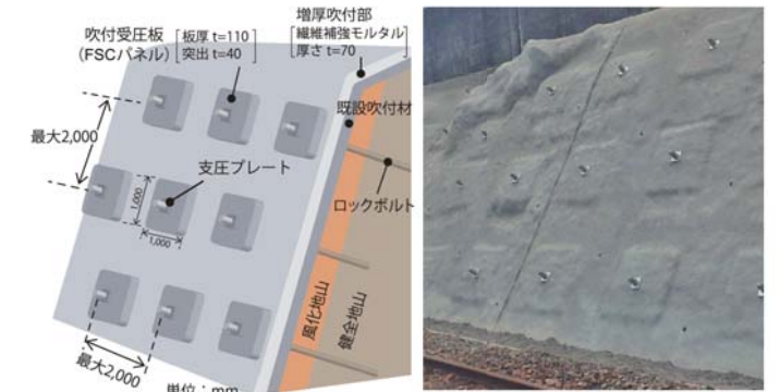
モデル図と施工完了後写真
