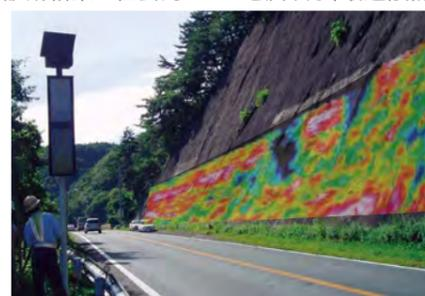
診断手法：熱赤外線映像法、たわみ振動法
