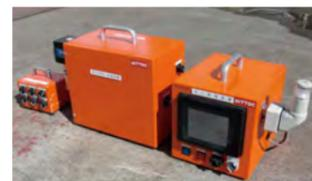
日特建設独自のシステムで、基材と可塑性剤の流量を計画配合となるように制御します。
