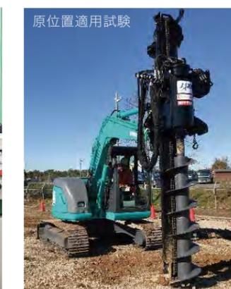
スクリーオーガの掘削抵抗を使って地盤強度を推定する技術を、月面探査だけでなく地上の工事でも応用することを目的に研究を行いました。当社の杭基礎工事の技術を活用し、地上工事への応用のための試験を実施しました。
