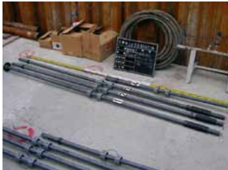
写真-4 小口径杭の芯鉄筋
