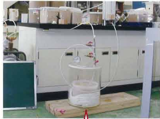
室内注入試験状況
