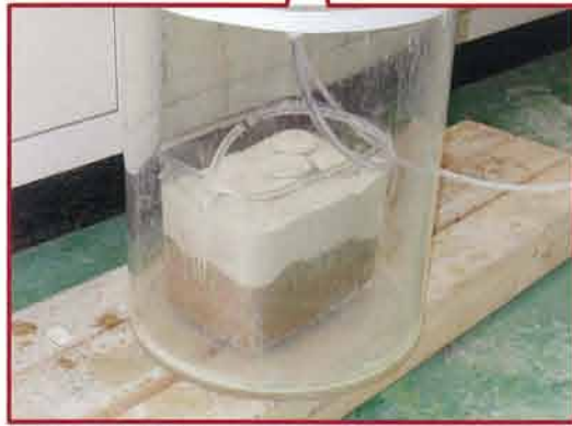
浸透注入固結体作成
